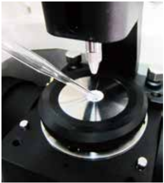
第五步：用滴管把样品滴到液体支架的凹槽内并充满。
